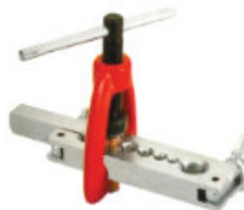
Abocinados a 45° en tubos de cobre, latón, aluminio y acero dulce. Puente de centrado automático, sin deslizamiento del tubo. Cono abocinador endurecido. Fabricado según normas UNE 16.563-1.
